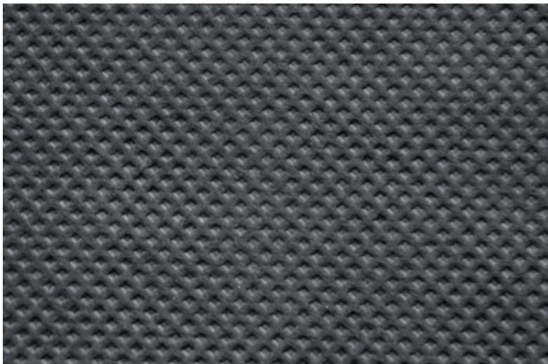
Рис. 2. Термоскрепленный спанбонд «агротекс 60».
