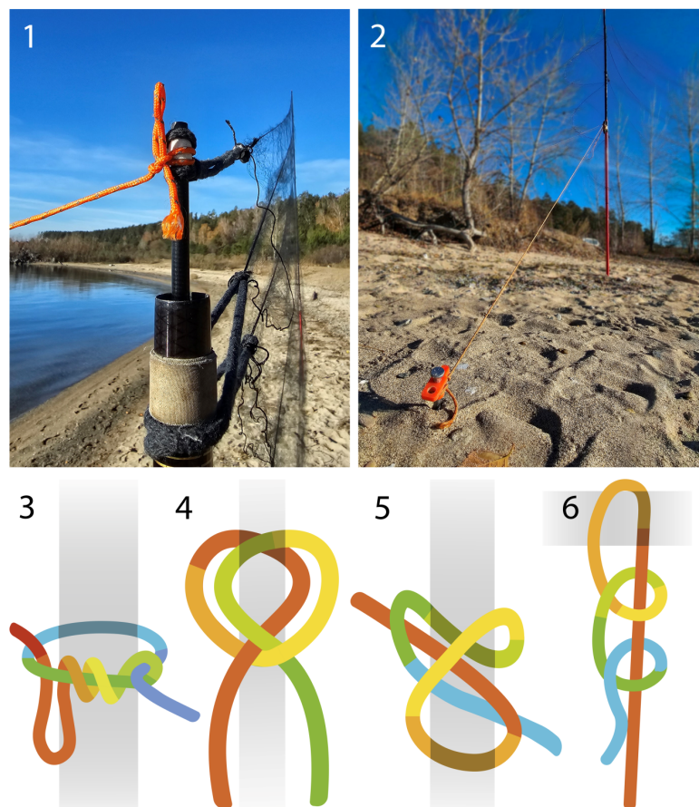
Рис. 4. Методы крепления оттяжек для стабилизации вертикальных стоек: 1 – крепление верхней оттяжки; 2 – классический способ фиксации стойки с помощью оттяжек, закрепленных на колышках; 3–6 – схемы узлов, используемых для крепления и регулировки оттяжек: «удавка» (3), «стремля» (4), «констриктор» (5), «штык» (6)
