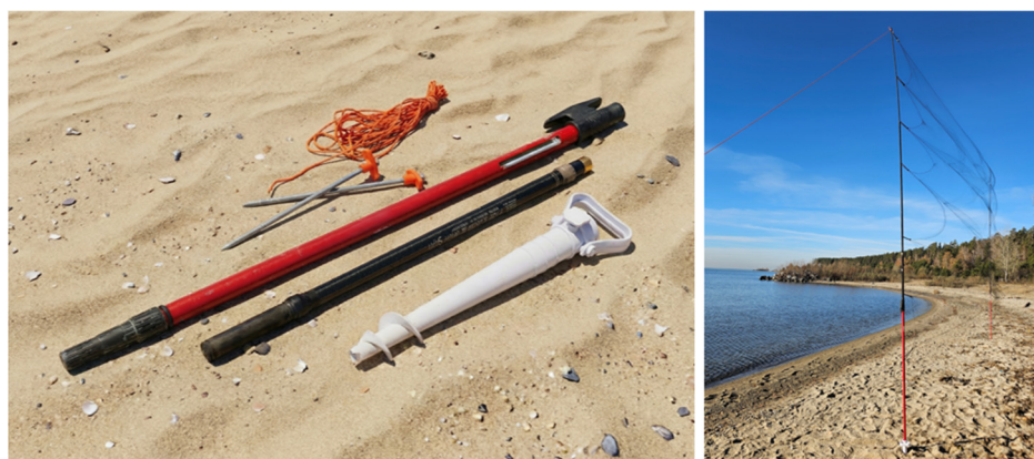
Рис. 3. Пример модифицированной вертикальной стойки и сопутствующего снаряжения в транспортном и рабочем положениях
